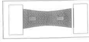
Slika 7d. Skupljanje horizontalnog kompozitnog sloja koji spaja nasuprotne zidove, snaga sveze je manja od snage stresa
