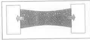
Slika 7c. Skupljanje horizontalnog kompozitnog sloja koji spaja nasuprotne zidove u gel točki
