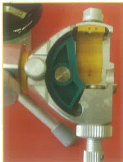
Slika 8. Nastavci za prilagodbu putanje kondilne staze i Bennettove kretnje integrirani u zglobni nastavak artikuladora
