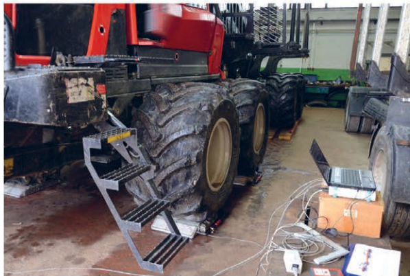
Slika 4. Utvrđivanje točke težišta forvardera
