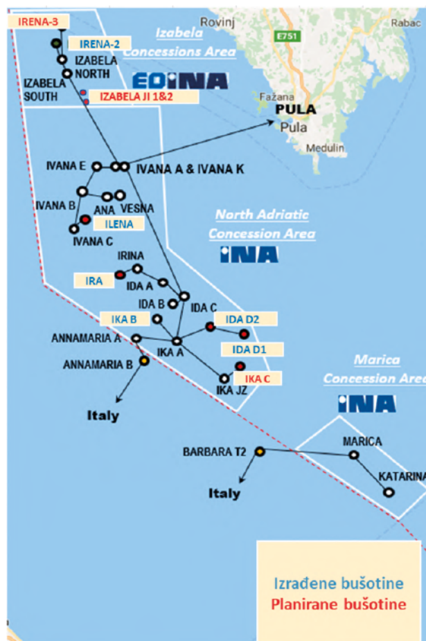
Slika 5. Karta eksploatacijskih polja na sjevernom Jadranu s lokacijama izrađenih i planiranih bušotina u trenutnoj kampanji
