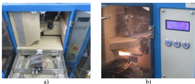
Slika 7. Uređaj za ispitivanje otpornosti materijala na udar malih prskotina rastaljenog metala: a) prije provedbe ispitivanja; b) za vrijeme provedbe ispitivanja
