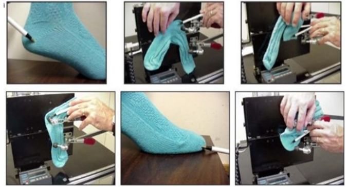
Slika 4. Postupak ispitivanja istezljivosti tijela i stopalnog dijela čarape u smjeru duljine na uređaju HIFOMACO HT - 36L [7]
