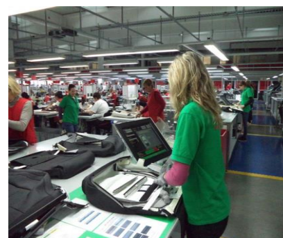
Sl.7 Završna kontrola po završetku tehnološkog procesa šivanja navlaka za automobilska sjedala
