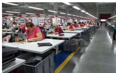
Sl.6 Proizvodna linija u tehnološkom procesu šivanja navlaka za automobilska sjedala
