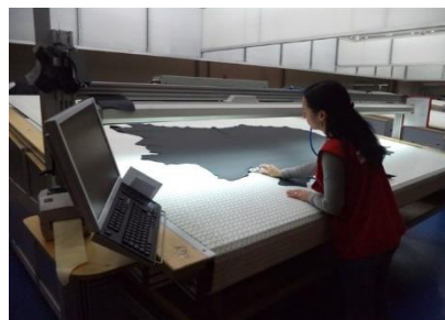
Sl.2 Pregled komada kože i bilježenje uočenih oštećenja
