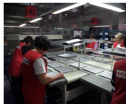
Sl.3 Ulaz krojnih dijelova u termo-tunel radi aktiviranja ljepila za laminiranje
