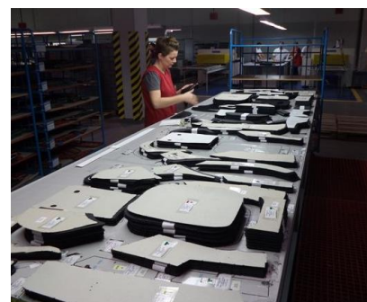
Sl.4 Sortiranje i provjera dijelova navlake za sjedala nakon faze iskrojavanja
