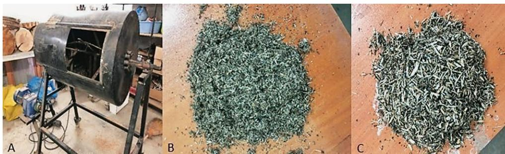
**Figure 1** A) Gluing machine, B) Surface layer blend, C) Core layer blend
