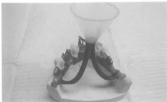
Slika 14. Voštana konstrukcija pripremljena za ulaganje
