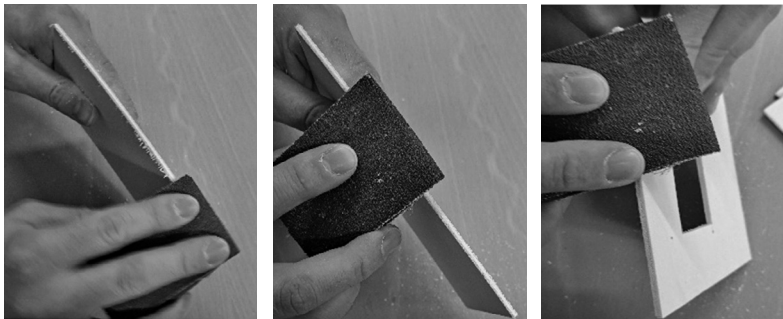
Slika 5. Postupak brušenja bridova brusnim papirom 800
