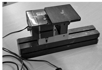
Slika 1. Stroj UNIMAT za sigurno piljenje šperploče
