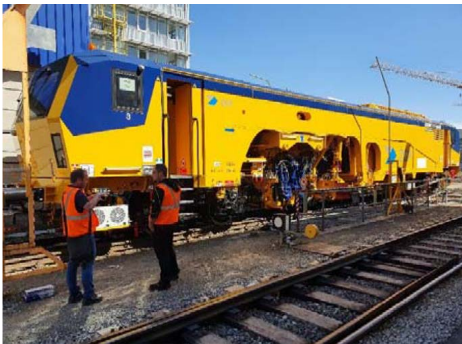
Slika 1. EZ provjera RST Plasser@Theurer UNIMAT 08-4X4/4S, Modul SB+SD
