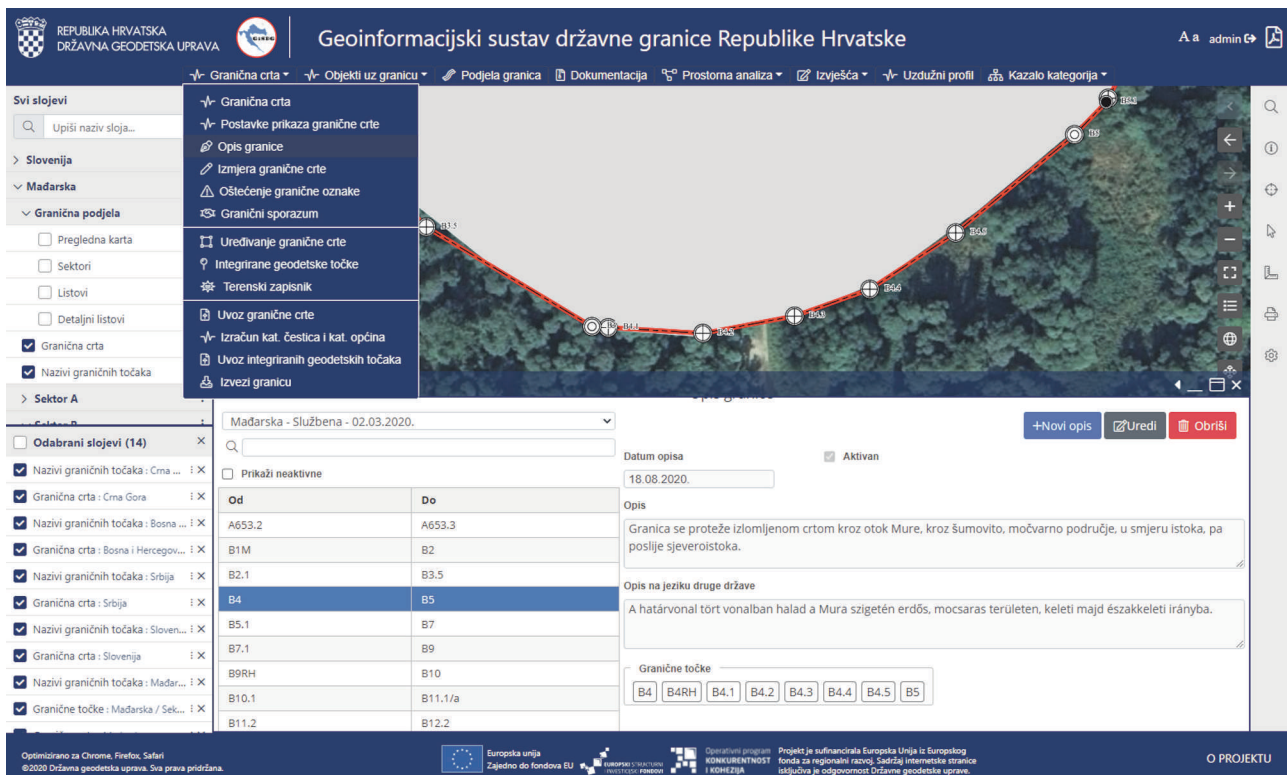
Fig. 8 Borderline module with the Border Description module from which the Border Description document is generated. Slika 8. Modul Granična crta s prikazanim modulom Opis granice iz kojega se generira dokument Opis granice.
