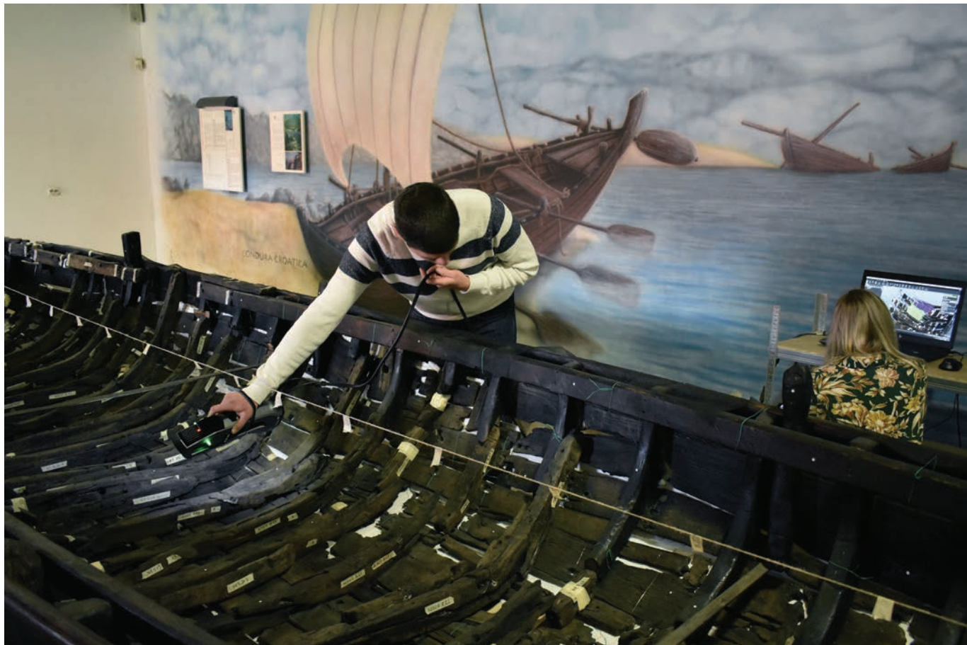
Slika 4. Postupak 3D skeniranja ručnim GO!SCAN SPARK 3D skenerom
