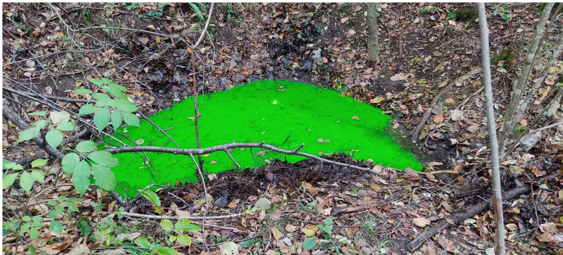
Slika 4. Trasiranje ponorne zone potoka Plitvica Na-fluoresceinom
