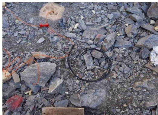
Slika 11. Minsko polje spremno za aktiviranje
