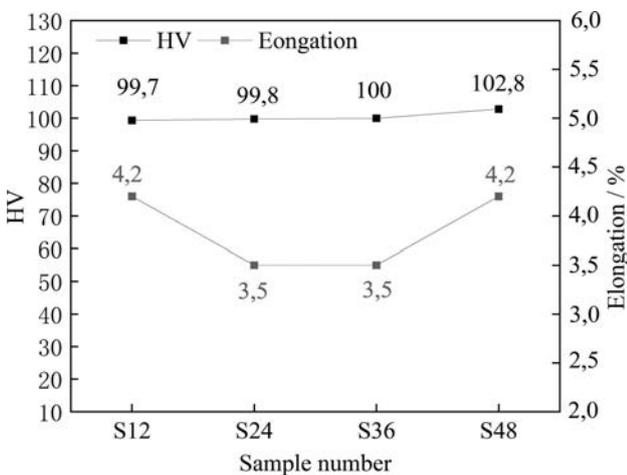
Figure 4 Mechanical properties (a) S12, (b) S24, (c) S36, (d) S48.
