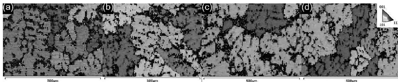
Figure 2 EBSD diagram of the alloy (a) S12, (b) S24, (c) S36, (d) S48
