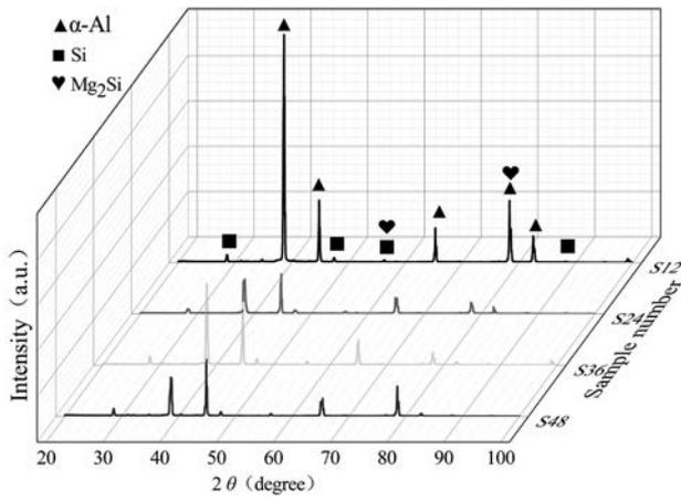
Figure 3 XRD diffraction pattern (a) S12, (b) S24, (c) S36, (d) S48.
