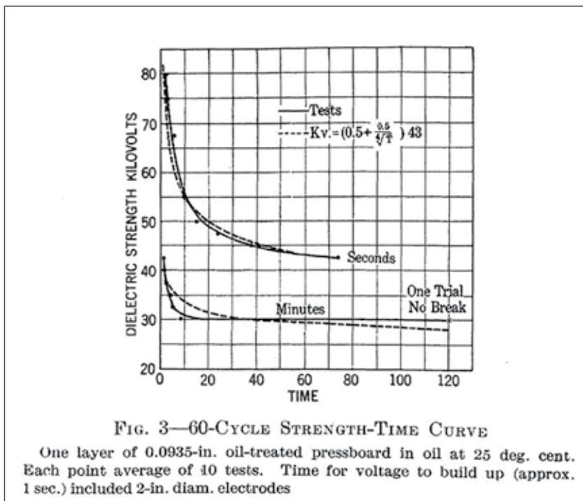
FIG. 3—60-CYCLE STRENGTH-TIME CURVE
