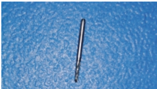
Slika 3. Tungsten karbidno svrdlo Figure 3. Tungsten carbide bur
