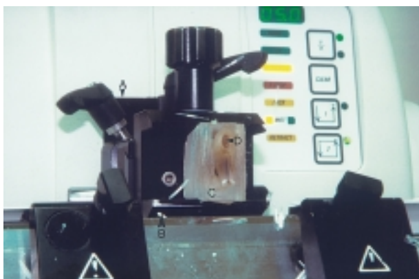
Slika 1. Rotacijski mikrotom za kost Leica RM 2155 (A) s wolfram-karbidnim nožem (B) za rezanje tvrdih i mineraliziranih tkiva. Plastični blok (C) s eksperimentalnim zubima montiran je na uređaj i orijentiran tako da se presjek mandibularnoga kanala (D) nalazi gore.
