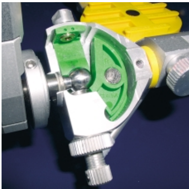
Slika 2. Zeleni umetci za kondilnu putanju i Bennettov kut Figure 2. Green condylar and Bennett guidance
