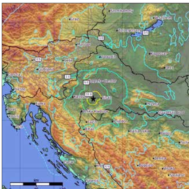
10 Prikaz izolinija a) Intenzitet b) PGA – peak ground acceleration – vršno ubrzanje tla i c) PGV – peak ground velocity – vršna brzina tla za potres 29. prosinca 2020. godine u 12 sati i 19 minuta. Podaci su prikupljeni sustavom SeisComP i obrađeni sustavom ShakeMap 4.
