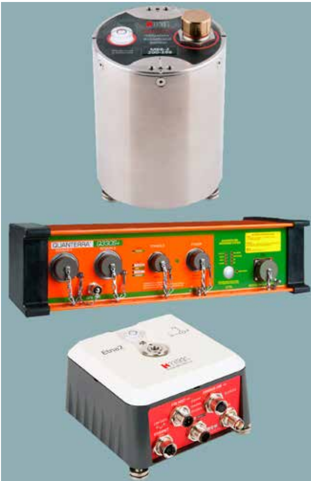
3 Oprema nabavljena iz donacije Vlade RH 2021. godine. Od gore prema dolje: seizmometar MBB-2, digitalizator podataka Q330S+ i akcelerograf ETNA2.
