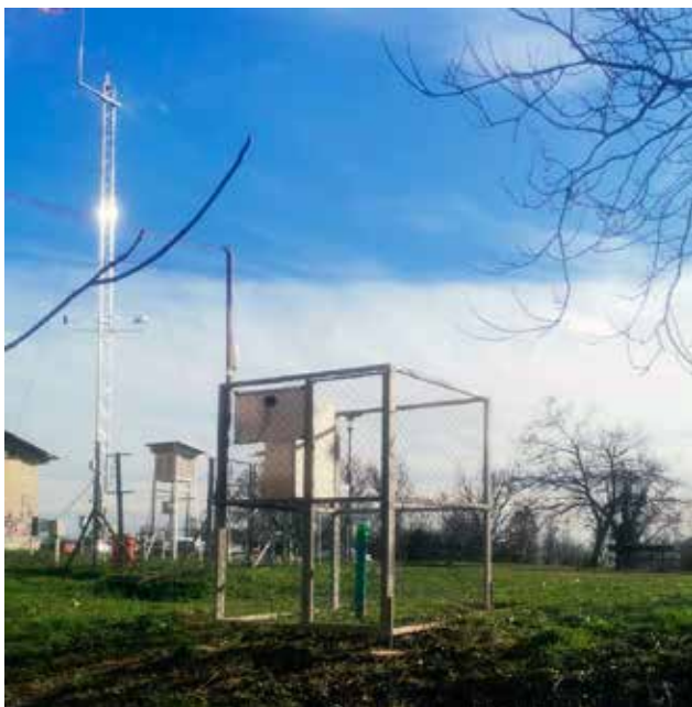
1 Prva bušotinska postaja u RH. Korištena oprema je post-hole instrument tvrtke Guralp Systems Ltd. (model Radian post-hole) i digitalizator Minimus (Guralp Systems Ltd.). Oprema je nabavljena zahvaljujući donaciji tvrtke Termostroj d.o.o. a bušotina je izvedena donacijom tvrtke Geotehnički studio d.o.o. Ogradu oko postaje je donirao Geofizički odsjek PMF-a.
