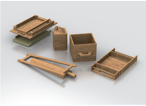
Sl. 8. Kalupi za izradu opeka, prema W. Czysz (izradio: Vedran Hunjek, Silikon studio d.o.o. Varaždin).
