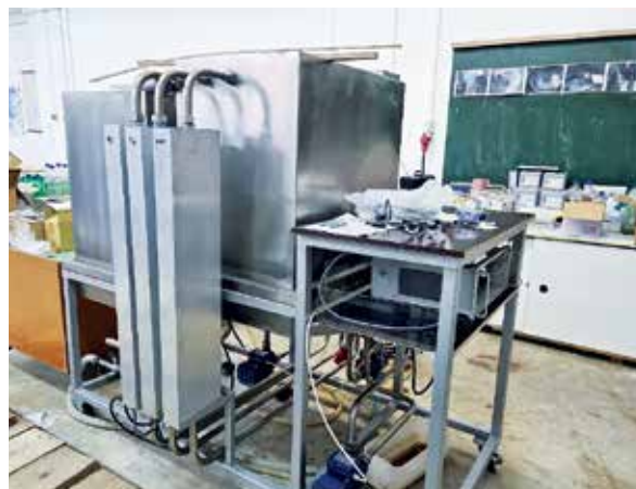
Slika 1: Pilot uređaj za pročišćavanje zauljenih otpadnih voda iz mokrog skruberu elektrokemijskim postupcima
