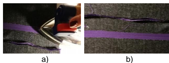
Slika 3. Šavovi korzeta a) Razglašavanje šavova s parnim glačalom i b) razglašani i ne razglašani šav (autorski rad).
