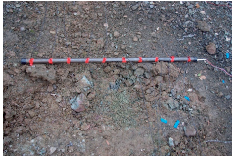
Slika 3: Postav mjerjenja brzine detonacije u čeličnim cijevima.
