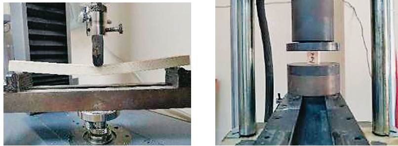
Figure 3 Bending strength and compressive strength test image Slika 3. Prikaz ispitivanja čvrstoće na savijanje i čvrstoće na tlak
