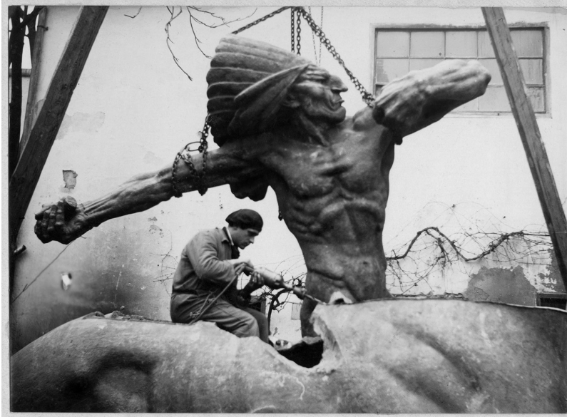
Slika 4. Proces lijevanja skulptura Indijanaca – spajanje brončanih dijelova. Ljevaonica umjetnina Akademije likovnih umjetnosti u Zagrebu, 1927. Autor fotografije: Svetozar Prodanović. Fototeka Galerije Meštrović, inv. br. FGM-1164/13
