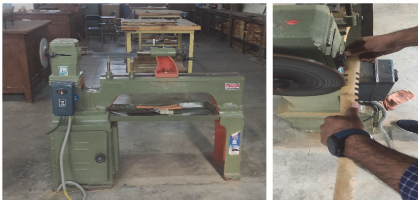
Slika 2. Tokarski stroj te prikaz izrade utora
