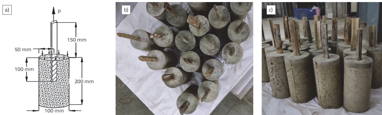
Slika 5. a) Shematski prikaz uzorka za ispitivanje čupanjem; b) Originalni ispitni uzorak za ispitivanje čupanjem
