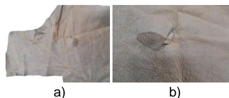
Slika 1. Nedostaci na koži: a) oštećenja, b) promjena boje (autorski rad)
