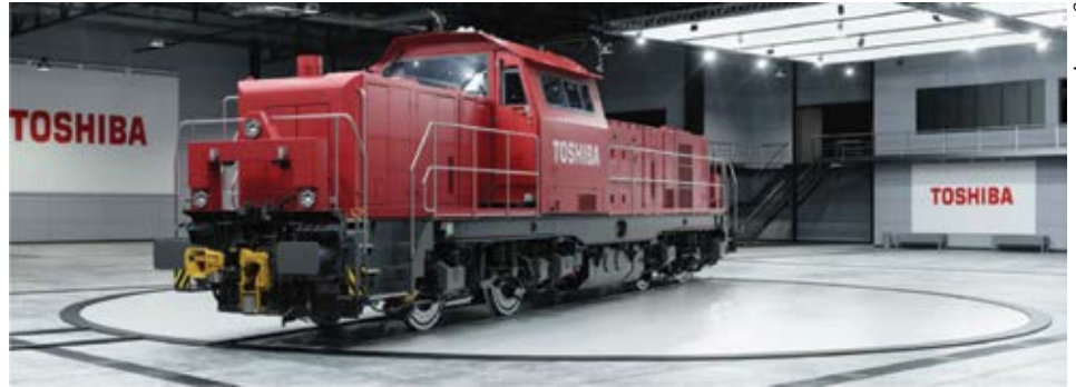
Slika 3. Hibridna lokomotiva T-HDB 800
