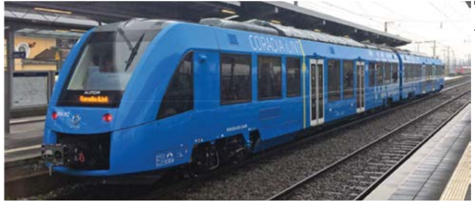
Slika 5. Hibridni vlak s gorivnim člancima Coradia iLint
