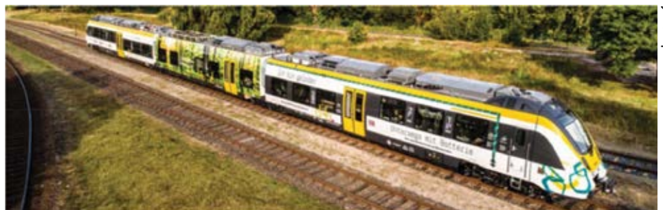
Slika 7. Hibridni vlak Talent 3 BEMU
