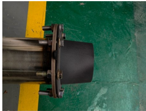
Fig. 5 Convergent nozzle ejector
