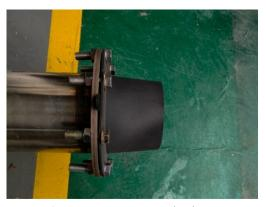
Fig. 5 Convergent nozzle ejector
