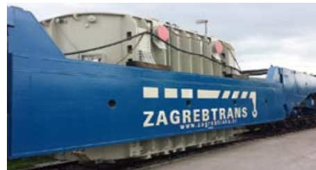
Slika 5. Natovareni transformator u prostoru tvornice
