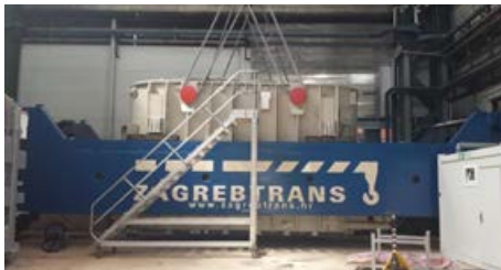
Slika 4. Ukrcaj transformatora u prostoru tvornice
