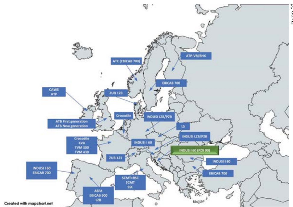
Slika 1. Pregled europskih nacionalnih sustava automatske zaštite vlakova (ATP – Automatic Train Protection – sustavi klase B prema Prilogu II. Uredbe (EU) 2023/1695)
