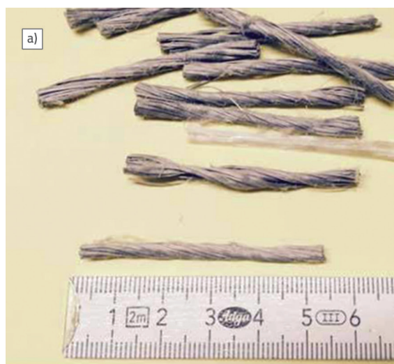
Slika 16. a) Polipropilenska vlakna "AWP Forta Ferro"; b) Beton s polipropilenskim vlaknima [3]
