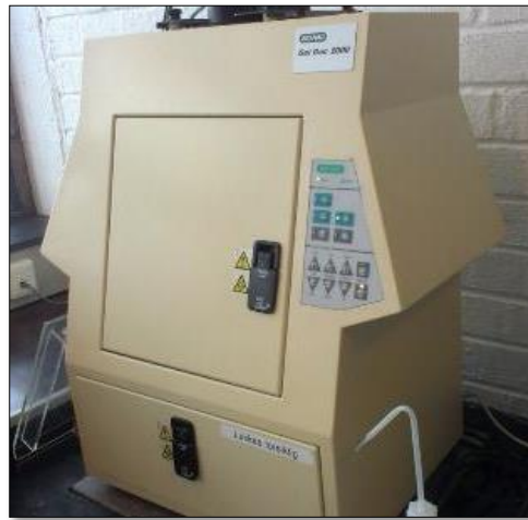
Slika 6. UV transiluminator – Uređaj za vizualizaciju i očitavanje rezultata s elektroforeze Figure 6. UV transilluminator – Device for visualizing and reading results from electrophoresis
