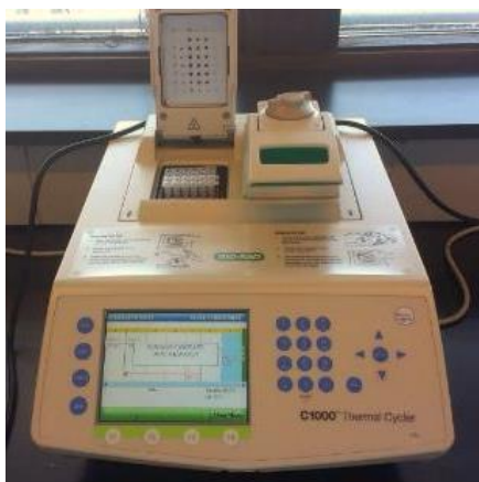
Slika 4. PCR Termalni ciklus korišten za umnožavanje DNA Figure 4. PCR Thermocycler used for DNA amplification
