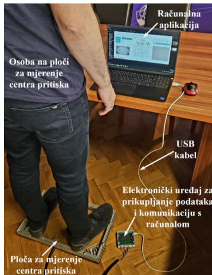
Slika 4.1: Mehatrički sustav za procjenu ravnoteže ljudskog tijela
