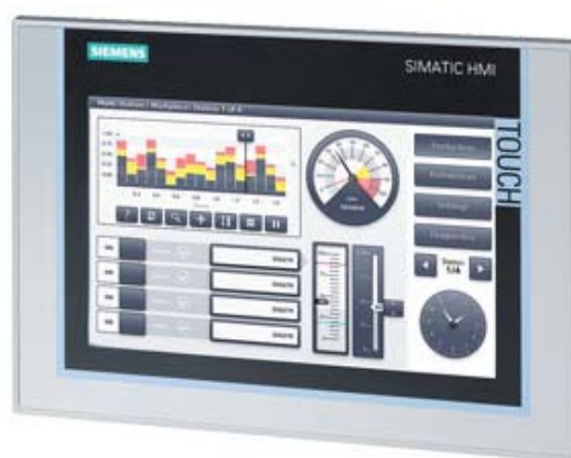
Slika 2. Primjer PLC-a korištenog u ovom radu S7 HMI tp900 comfort
