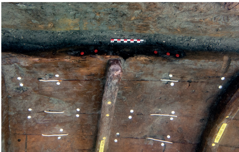
Slika 9 Utor i željezni čavli na lijevom boku broda, uz rebro TR2.F9p (foto: D. Taras)
