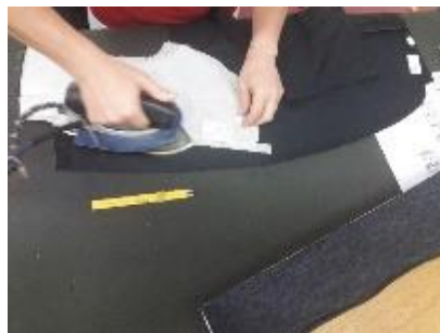
Sl.34 Montiranje prsluk pojačanja s bilježenjem pregiba [8]
