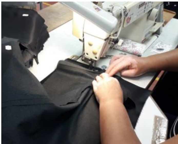
Sl.3 Šivanje podstave na duljinu rukava sa zatvorenim rasporkom [8]
