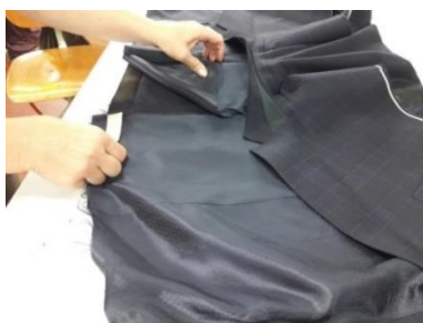
Sl.17 Označavanje duljine sakoa [8]
