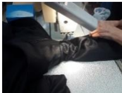
Sl.31 Zatvaranje otvora na podstavi rukava [8]
