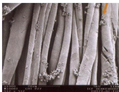
Sl.5 SEM snimka zemnoalkalijskog finokristaliničnog taloga iz kupelji koja ne sadrži karbonate, povećanje 1000x [59]
