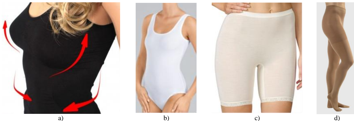
Sl.4 Odjevni predmeti izrađeni od elastičnog pletiva: a) ženska potkošulja s gaćicama (bodi) izrađena sa 97 % PA i 3 % elastana, b) ženska potkošulja s gaćicama izrađena s pamučnom pređom finoće 17 tex i elastanskom pređom finoće 33 dtex, udio pamuka 95 % i elastana 5 %, c) ženske zimske gaće izrađene s vunenom pređom finoće 14 tex (veoma velika finoća vlakana - 14 \mu m) i elastanskom pređom finoće 44 dtex, udio vune 90 % i elastana 10 %, d) ženske preventivne čarape s gaćicama izrađene s PA multifilamentnom pređom finoće 60 dtex i elastanskom jednostruko omotanom pređom finoće 56/33/17 dtex
