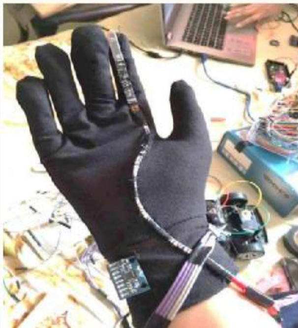
Slika 9. Rukavica za pokretanje motornih invalidskih kolica s tri komponente: fleksibilnim senzorom, žiroskopom i odašiljačem za bežičnu vezu [15]
