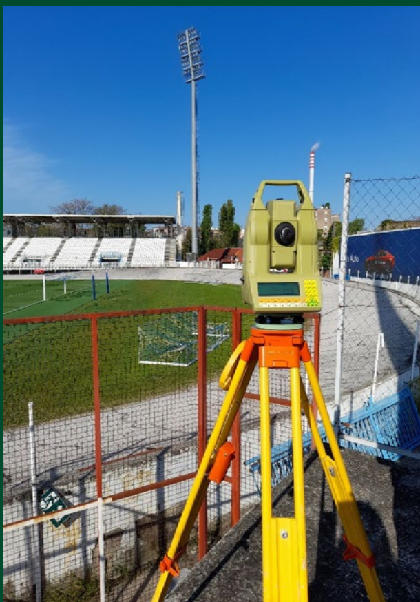
Slika 5. (a) Precizna geodetska mjerna stanica Leica TC2003, (b) prizma Leica GPR121.
