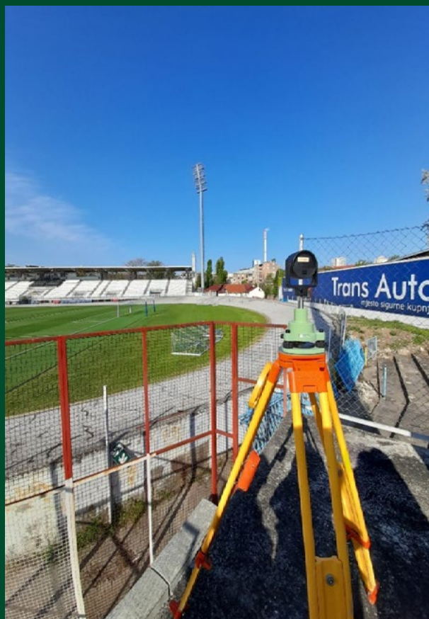
Slika 5. (a) Precizna geodetska mjerna stanica Leica TC2003, (b) prizma Leica GPR121.
