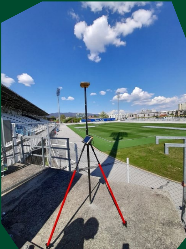
Slika 4. GNSS RTK mjerenja na geodetskoj točki D.
