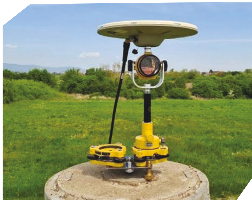
Slika 6. Stabilizacija točke T nakon simulacije pomaka u epohi E1.
