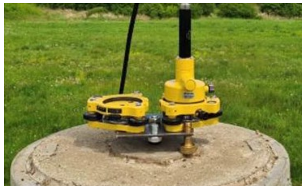
Slika 3. Način simulacije 3D pomaka točke T.
