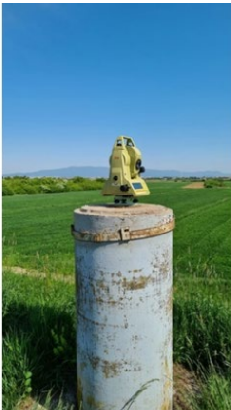
Slika 4. Način stabilizacije točaka referentne mreže: a) točka A; b) točke B i C.
