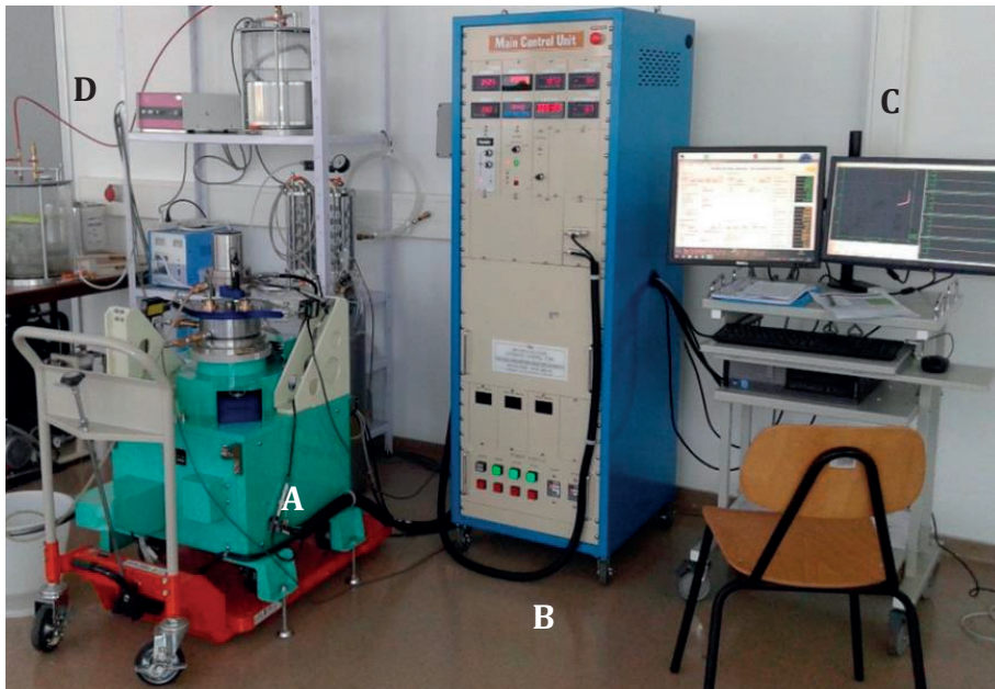
Slika 2. Uređaj za prstenasto smicanje, ICL-1 u Geotehničkom laboratoriju Građevinskog fakulteta Sveučilišta u Rijeci: A – instrumentna jedinica, B – nadzorna jedinica, C – kontrolna jedinica, D – sustav za deaeriranje vode, saturaciju uzorka i kontrolu pornih pritisaka
