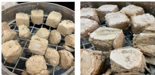
Slike 31.- 32. Prikaz ispitanih uzoraka šarene miljevine, oznake 24/368, razorenih magnezijevim sulfatom (lijevo) i natrijevim sulfatom (desno) [27]
