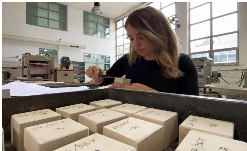
Slika 23. Mjerenje dimenzija ispitnih uzoraka u Centralnom laboratoriju IGH d.o.o. Mostar [27]
