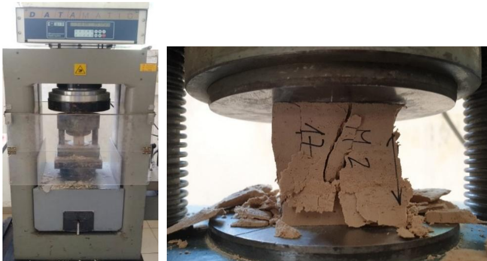
Slike 11.- 12. Presa za ispitivanje tlačne čvrstoće sa adapterom
