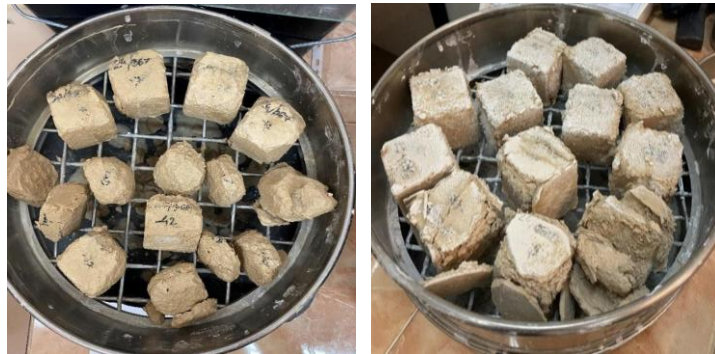
Slike 36.-37. Prikaz ispitanih uzoraka bijele miljevine, oznake 24/367, razorenih magnezijevim sulfatom (lijevo) i natrijevim sulfatom (desno) [27]
