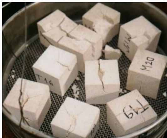
Slika 17. Slom uzoraka tenelije (nove) i miljevine (nove) i prekid ispitivanja nakon samo 3 od planiranih 25 ciklusa smrzavanja i odmrzavanja u IGH-MOSTAR 2002. godine [26]
