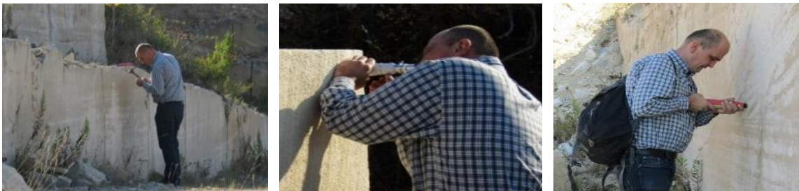
Slike 13.-15. Ispitivanja (mostarske) miljevine (nove) iz ležišta Mukoša kod Mostara ručnim mikroskopom i Schmidt-ovim čekićem, uz vizualni pregled (foto: K. Šaravanja) [4,5]
