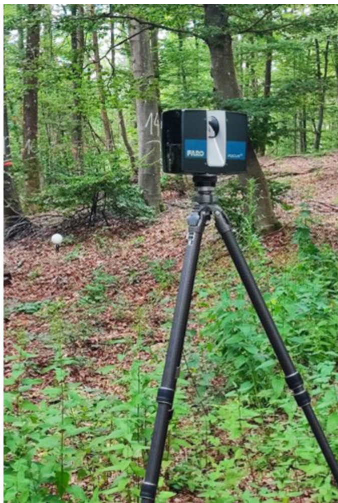
Slika 6: Statički terestrički laserski skener (TLS) Faro FOCUS M70 i bijela sfera za georeferenciranje TLS oblaka točaka s lijeve strane
