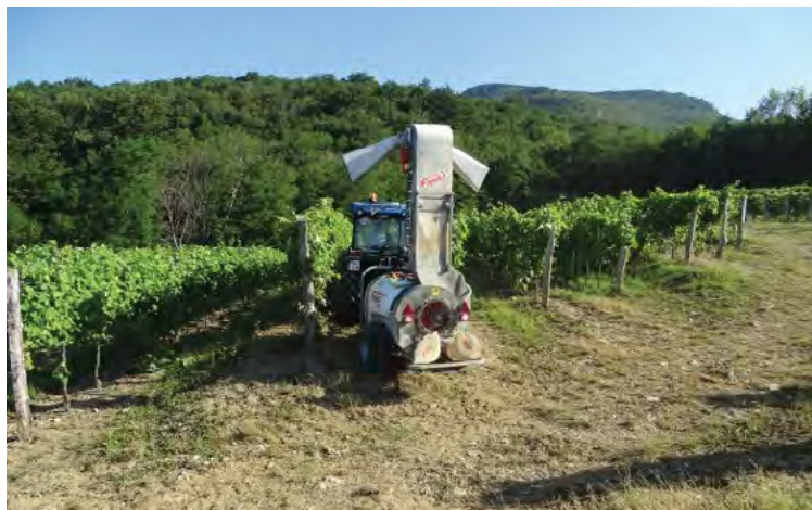
Slika 1: Radijalni orošivač Friuli Sprayers Compact T4 1000 sa dva donja i dva gornja usmjerivača zraka (difuzora) / Figure 1: Radial air-assisted sprayer Friuli Sprayers Compact T4 1000 with two lower and two upper air diffusers
