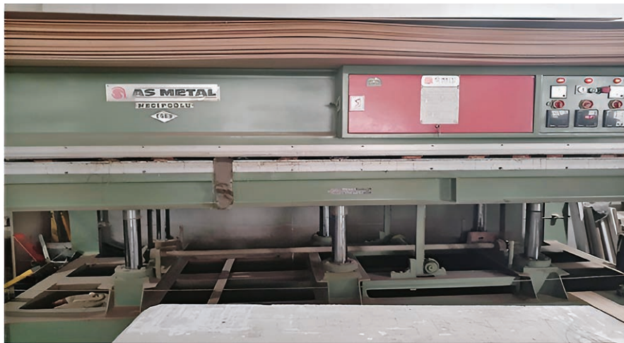
Figure 3 Pressing of test samples Slika 3. Prešanje ispitnih uzoraka
