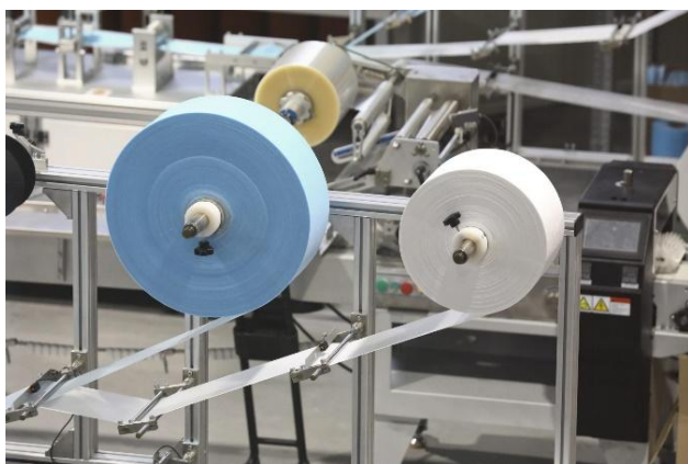
Sl.6 Automatski stroj za proizvodnju kirurških maski u tvrtki Splendor
